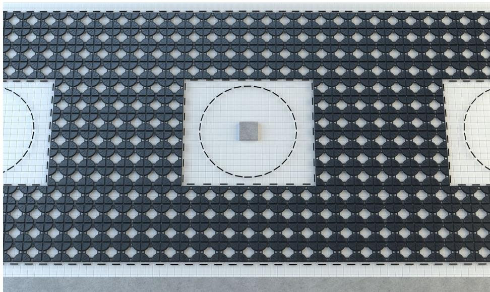
Les éléments de construction Cobiax sont disponibles pour des dalles en béton de 20 à 80 cm. Selon la sollicitation et le système statique, environ 50 à 80% de la surface des dalles sont recouverts de corps creux.
