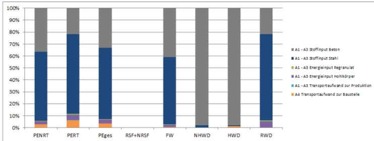
Die Wirkungsindikatoren werden ebenfalls durch den Produktionsprozess der Ausgangsstoffe Beton und Stahl maßgeblich (90-97%) beeinflusst. Insbesondere beim ODP, POCP und dem ADPF ist dabei der Stahlanteil für Biegebewehrung und Hohlkörperbewehrungskörbe dominant. Der Transport der Ausgangsstoffe zum Einbauort hat mit 0,1-3% nur geringen Einfluss auf die Wirkungsindikatoren. Lediglich beim Ozonbildungspotential (POCP) hat der Transport einen deutlichen
