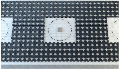
Les éléments de construction Cobiax sont disponibles pour des dalles en béton de 20 à 80 cm. Selon la sollicitation et le système statique, environ 50 à 80% de la surface des dalles sont recouverts de corps creux.
